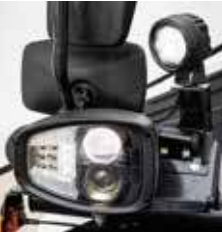
Pack d'éclairage routier LED : • feux de route • gyrophare • feu de recul
