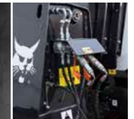
Hulphydrauliek op giekkop met FCS*
