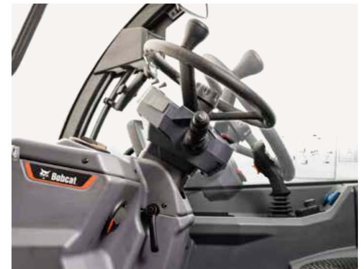
Kantelbare en telescopische stuurkolom
