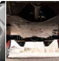
Plaque de protection en acier en partie basse
