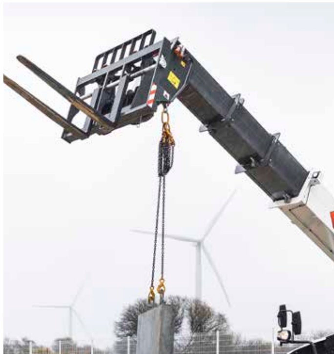
Anneau de levage sur tête de flèche (selon modèle)
