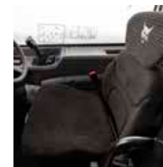
Siège à suspension pneumatique, avec appuie-tête
