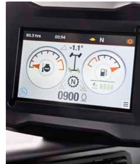
Écran LCD 5" avec molette de navigation
