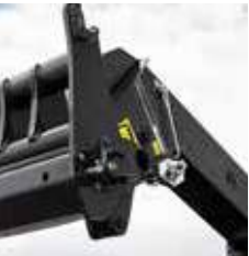
Hydraulische aanbouwdeelvergrendeling met een speciale hulpleiding
