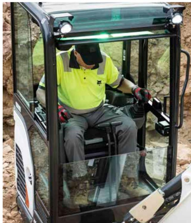
Cabine TOPS / ROPS avec chauffage
