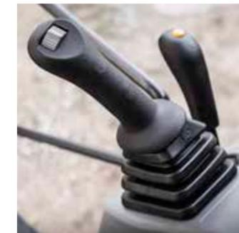
Commande par manipulateurs hydrauliques
