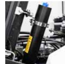
Suspension de flèche (accumulateur d'azote)
