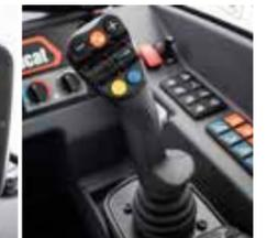
Manipulateur Smart avec fonction de position flottante de la flèche et secouage du godet
