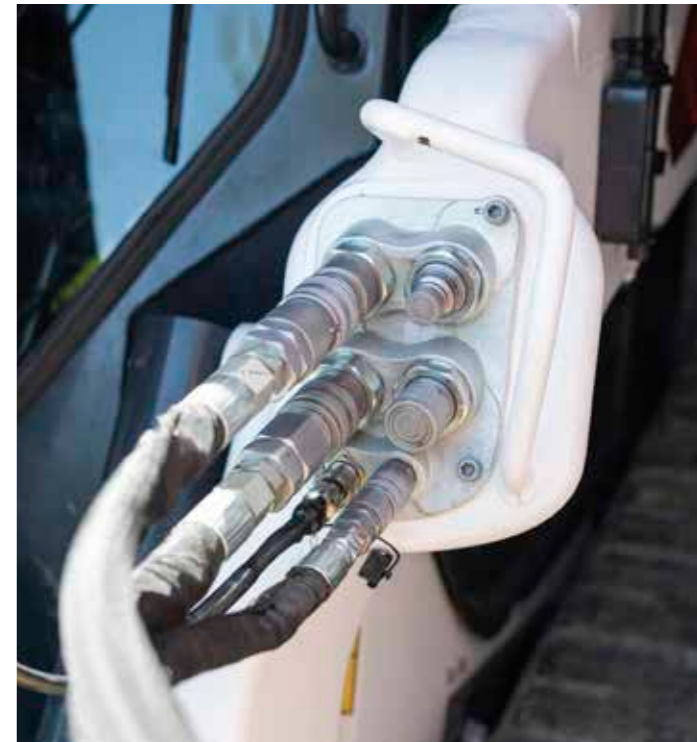
Bloc de connexion à 5 raccords pour la fonction Super Flow
