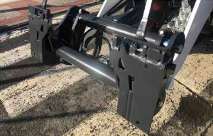
Quicktach naar Bob-Tach adapter (vereist voor alle aanbouwdelen behalve bakken en palletvorken)
