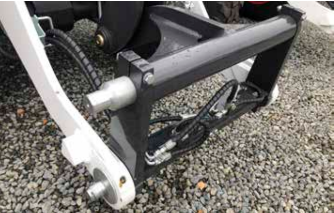
Quicktach-koppeling (standaard geïnstalleerd)
