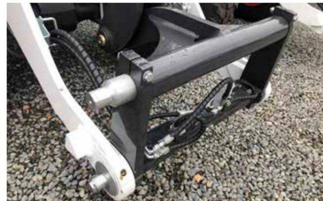
Raccord Quick-Tach (installé de série)
