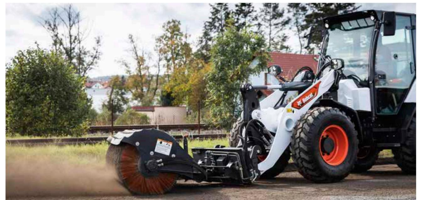
L85 équipée d'une balayeuse orientable
