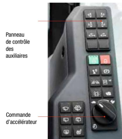
Panneau de contrôle des auxiliaires
