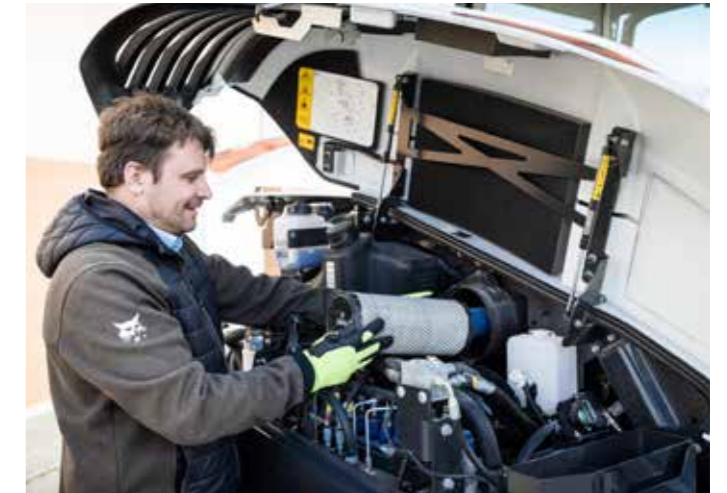
Remplacement des filtres
