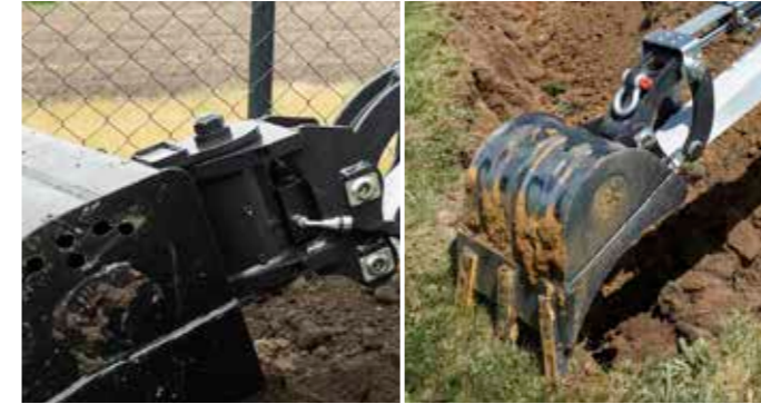
Raccord mécanique de type allemand (MS01) avec fonction de cavage
